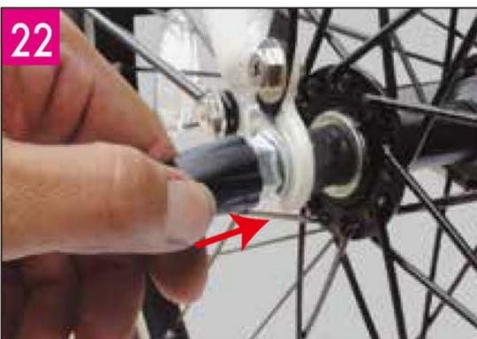
最後に全てのネジを緩みがないように付属のスパナでしっかりと締め、ハブキャップを取り付けて完了です。※商品保護のため、予め1個は装着済みです。
