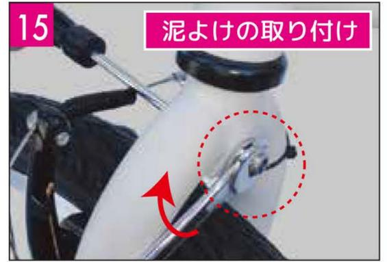
15 フロントフォークの後側中央のネジとワッシャーを前側のネジを押しえながら取り外してください。
