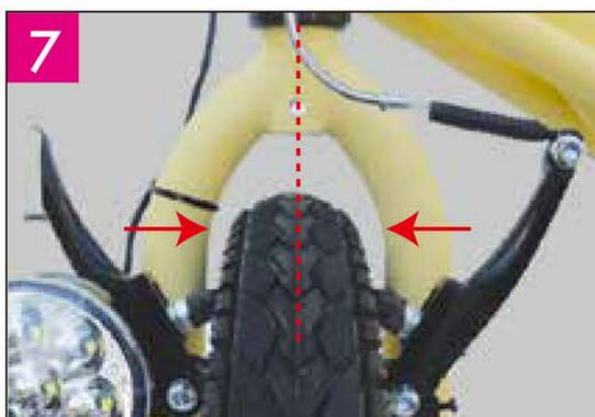
左右のナットは、タイヤがフロントフォークのセンターになるように調整しながらバランスよく締めてください。タイヤがセンターで無かったり、ナットの締まりがゆるいとブレーキは左右対称に握れません。(ナットはしっかりと締めてください。)
