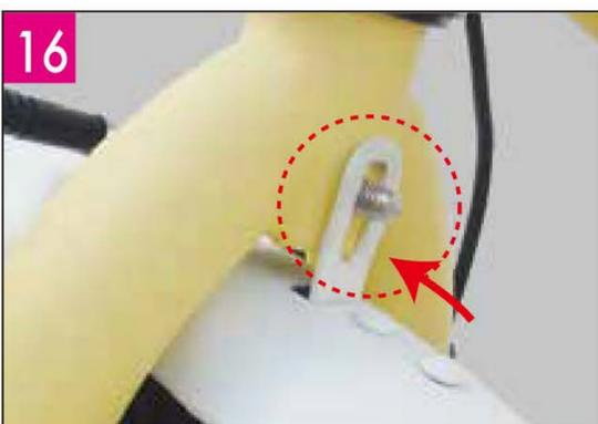
16 後側から泥よけカバーを差し込み、フックをネジに合わせて、15で外したネジで止めてください。
