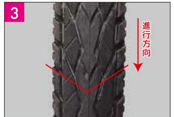
フロントフォークを差し込む前に前輪タイヤの向きを確認してください。※(タイヤの溝の方向に注意)
