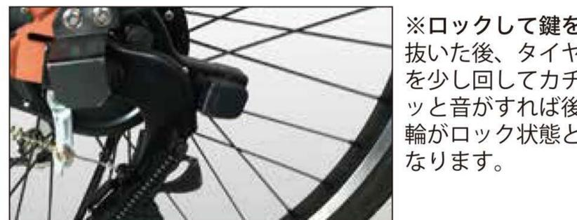
※ロックして鍵を抜いた後、タイヤを少し回してカチッと音がすれば後輪がロック状態となります。
