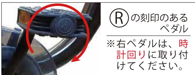
ペダルには左右の区別があります。ペダルを取り付ける際には、まずペダルの左右を確認してください。ペダルの左右はネジ山先端部分（平面になっている箇所）に刻印されています。
