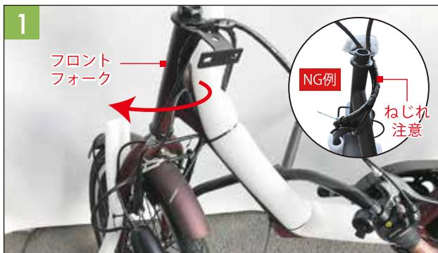
はじめに前輪とフロントフォークが、後ろ向きになっていますので、矢印の方向に回転させてください。
