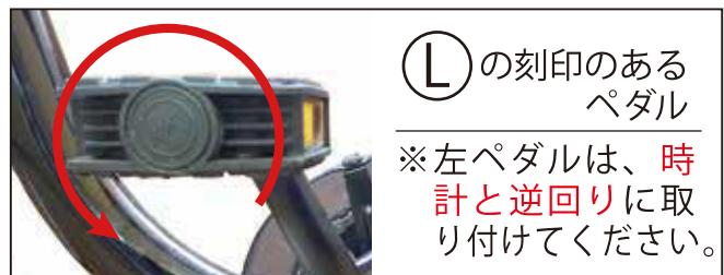
**注意** ペダルが入りにくいときは無理をせずに、再度左右を確認してください。無理矢理ペダルをねじ込んで装着しようとすると、大変不安定になるだけではなく、クランクのネジ山が削れてペダルが脱落し、大変危険です。また、クランクの修理も不可能になりますので、十分にご注意ください。
