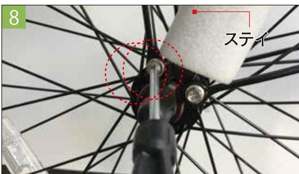
タイヤ、泥除け、前かごステイが擦れていないことを確認して、各部のネジを付属の工具で増し締めしてください。
