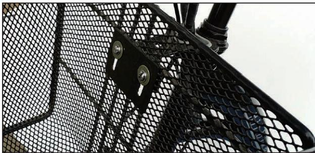
① 前カゴをハンドル前方のステイに沿わせてネジ穴にネジを差し込みます。
