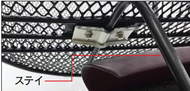
③ 底部を固定する板ナットの溝と、ステイを合わせてカゴの上からネジを差し込み、軽く締めて固定します。
