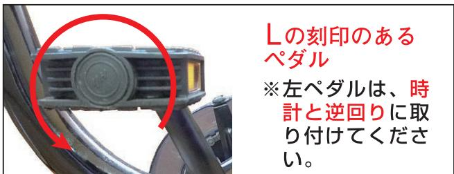
**注 意** ペダルが入りにくいときは無理をせずに、再度左右を確認してください。無理矢理ペダルをねじ込んで装着しますと、大変不安定になるだけではなく、クランクのネジ山が削れてペダルが脱落し、大変危険です。また、クランクの修理も不可能になりますので、十分にご注意ください。
