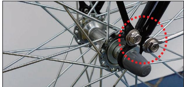
④ カゴを取り付けたあと、各部のネジをしっかりと締め付けて固定してください。**注）**特に、フロントフォークネジ穴とカゴステイの固定部分はしっかりと締め付けてください。
