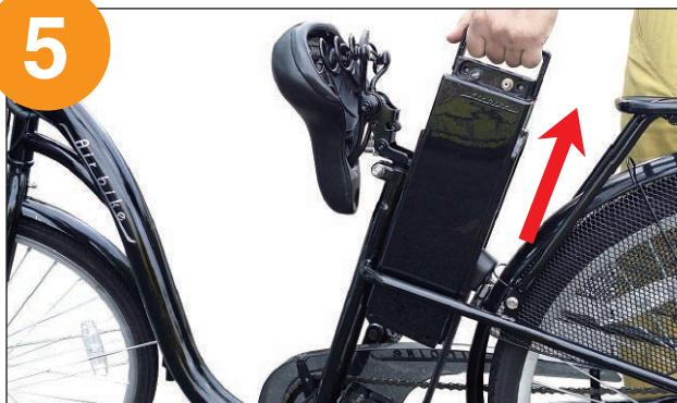
バッテリーを上(矢印の方向)に引き上げ取り出します。
